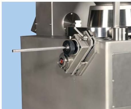
• Il dispositivo Attorcigliatore permette di essere approntato rapidamente senza uso di utensili. ■ The Twist Linker is ready quickly and without tools. ◇ El dispositivo Retorcedor permite de ser preparado rápidamente sin empleo de herramientas.
