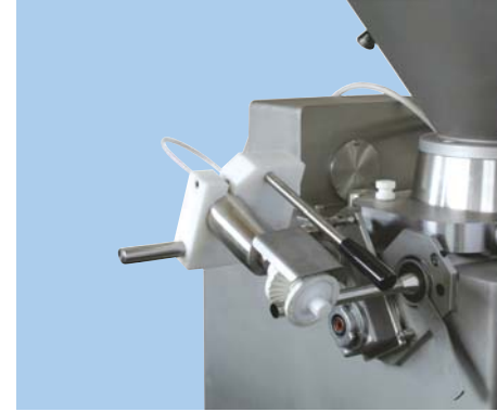
• L'Arricciatore permette di incrementare la produttività dell'operatore quando viene usato budello naturale. Un motore pneumatico consente di infilare rapidamente negli imbuto d'insacco tutti i budelli naturali senza danneggiarli. ■ The casing applier increases output when using natural casing. The pneumatic drive unit draws all natural casings over any filling tube without damaging them. ◇ El Llenador de tripa permite incrementar la productividad del operario cuando se utiliza tripa natural. Un motor neumático da la posibilidad de introducir rápidamente en los embudos de llenado todas las tripas naturales sin dañarlas.
